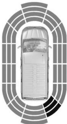
La plupart des objets se trouvant à proximité de l'arrière et, suivant équipement, de l'avant et des côtés du véhicule sont détectés
