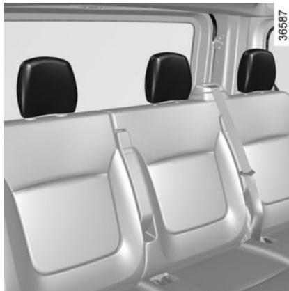
Introduisez les tiges de l'appui-tête dans les fourreaux (inclinez le dossier si nécessaire). Enfoncez l'appui-tête maximum, puis soulevez-le jusqu'à son blocage. Vérifiez le bon verrouillage de chaque tige **2** sur le dossier du siège.
