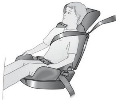
Dès 15 kg ou 4 ans l'enfant peut voyager sur un réhausseur qui permet d'adapter la ceinture de sécurité à sa morphologie. L'assise du réhausseur doit être munie de guides positionnant la ceinture sur les cuisses de l'enfant et non sur le ventre. Un dossier réglable en hauteur et équipé d'un guide sangle est conseillé pour placer la ceinture au milieu de l'épaule. Elle ne doit jamais être sur le cou ou sur le bras.
