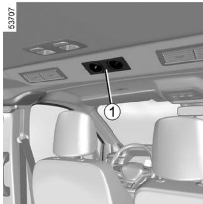
Lorsque le véhicule en est équipé, il dispose de quatre aérateurs orientables et du combiné de commandes **1**.
