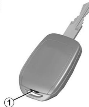
Ouvrez le boîtier par la fente **1**, à l'aide d'un outil type tournevis plat, et remplacez la pile **2** en respectant le modèle et la polarité gravée sur le fond du couvercle.
