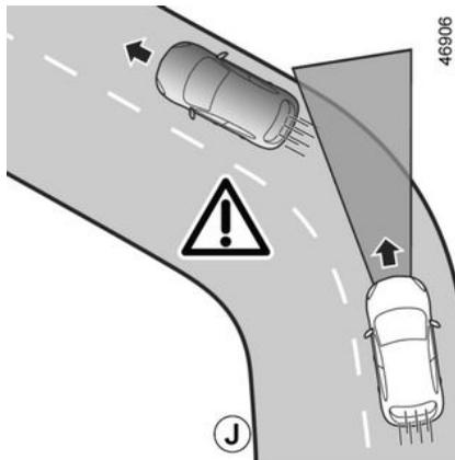
À l'entrée d'un virage et en courbe, la caméra peut ne plus détecter temporairement le véhicule précédent (exemple **J**).
