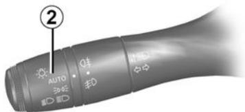
Automatiquement, les feux s'éteignent après l'arrêt du moteur, à l'ouverture de la porte conducteur ou au verrouillage du véhicule. Dans ce cas, au démarrage moteur suivant, les feux se rallumeront dans la position de la bague 2.
