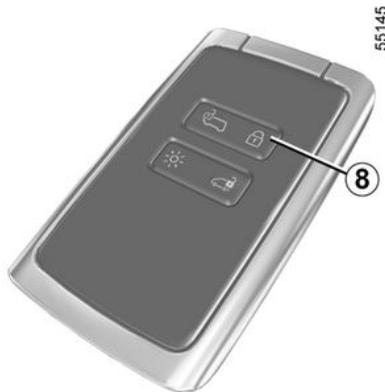
Au-delà de 15 minutes environ, carte dans la zone d'accès **3**, le verrouillage à l'éloignement du véhicule est désactivé. Pour verrouiller le véhicule, appuyez sur le bouton **8** de la carte.
