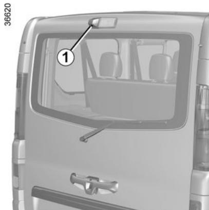
Au passage de la marche arrière, la caméra **1** située sur le hayon ou, suivant véhicule, sur la porte arrière battante, transmet une vue de l'environnement arrière du véhicule sur le rétroviseur **2** ou, suivant véhicule, sur l'afficheur multimédia **3** accompagné d'un ou de deux gabarits **4** et **5** (mobile et fixe).
