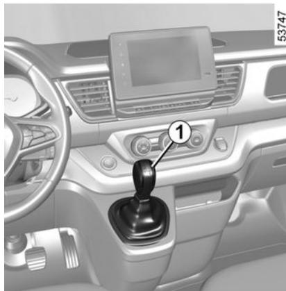
Engagez le levier de sélection **1** en position D, amenez le levier vers la droite jusqu'en position M.
