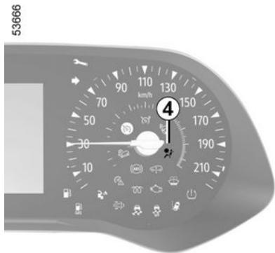
Le témoin **4**
