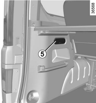
Déposez le diffuseur à l'aide d'un outil type tournevis plat.
