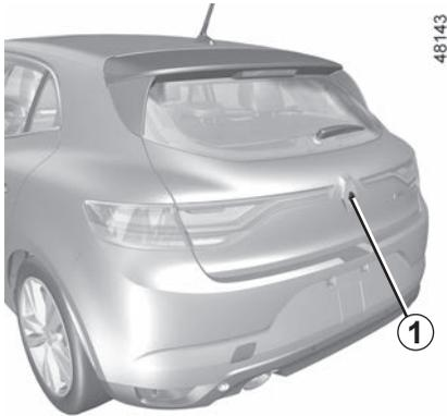
Die **1**-Rückfahrkamera befindet sich an der Gepäckraumklappe.
