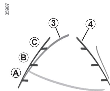
Diese Maßlinie ist feststehend und zeigt den Weg des Fahrzeugs bei gerade ausgerichteten Rädern an.
