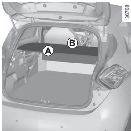
Die Gep ckraumabdeckung besteht aus einem starren **A** und einem faltbaren Abschnitt **B**.
