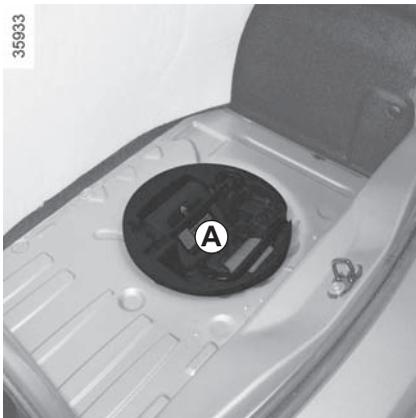
Das Vorhandensein der verschiedenen Werkzeuge in der Werkzeugbox ist abhängig vom Fahrzeugmodell. Das Bordwerkzeug befindet sich im Ablagefach unter der Gepäckraummatte **A**.
