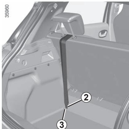
Der dritte Ring dient zur Befestigung des oberen Riemens bestimmter Kindersitze: Haken **2** **muss** an Ring **3** (bei einem Rücksitz) bzw. Ring **4** (für einen Vordersitz) befestigt und der Riemen anschließend strammgezogen werden.
