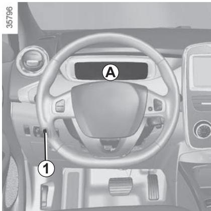
**Instrumententafel A:** wird beim Einschalten des Lichts beleuchtet. Die Helligkeit kann durch Drehen des Rändelrads **1** eingestellt werden.
