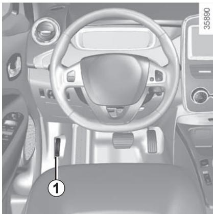
Zum Öffnen am Hebel **1** auf der linken Seite des Armaturenbretts ziehen.
