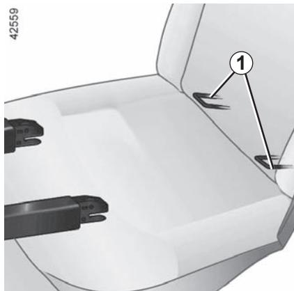
Die beiden Befestigungsbügel **1** befinden sich zwischen der Rückenlehne und der Sitzfläche des Sitzes; ihre Position ist durch eine Markierung gekennzeichnet.
