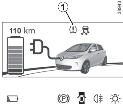
Wenn das Fahrzeug damit ausgestattet ist, gibt dieses System bei Druckverlust eines oder mehrerer Reifen eine Warnung aus.
