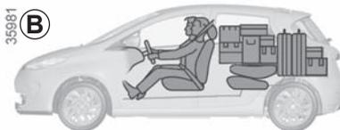
Wenn Sie Gegenstände auf die umgeklappte Rückenlehne laden möchten, müssen Sie die Kopfstützen zurückziehen, bevor Sie die Rückenlehne umklappen; dadurch kann die Rückenlehne maximal nach vorne gegen das Sitzbankkissen gedrückt werden.
