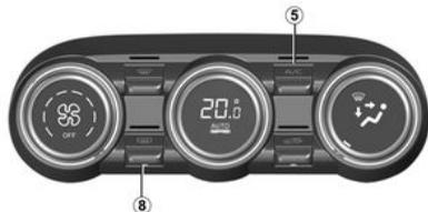
Drücken Sie die Taste **8**: Die integrierte Kontrolllampe leuchtet auf. Diese Funktion ermöglicht es, die Heckscheibe und die Außenspiegel entsprechend ausgestatteter Fahrzeuge schnell von Beschlag und Vereisung zu befreien.
