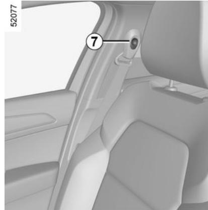
Stellen Sie mit Hilfe des Knopfs **7** die Höhe der Gurtbefestigung so ein, dass der Schultergurt wie oben beschrieben verläuft. Drücken Sie die Taste **7** und lösen Sie den Sicherheitsgurt aus oder senken Sie ihn ab. Vergewissern Sie sich, dass der Sicherheitsgurt richtig eingerastet ist, nachdem Sie ihn angelegt haben.
