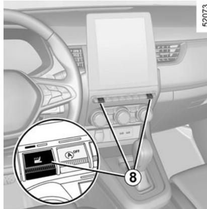
– wenn Sie den Schalter ein zweites Mal drücken, wird die Heizung auf „niedrige Stufe“ gestellt. Eine integrierte Kontrolllampe leuchtet auf;
