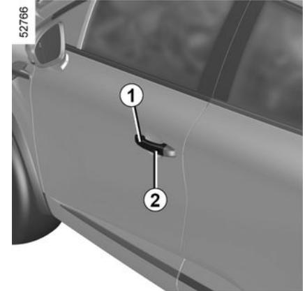
Wenn sich die Keycard im Bereich **3** befindet und das Fahrzeug verriegelt ist, drücken Sie je nach Fahrzeug die Taste **2** am Türgriff **1** einer der beiden Vordertüren: das Fahrzeug wird entriegelt. Ein Druckimpuls auf den Knopf **2** führt ebenfalls zur Entriegelung des gesamten Fahrzeugs.
