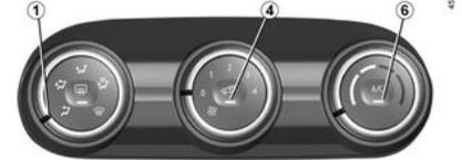
Drücken Sie die Taste **4**: Die integrierte Kontrolllampe leuchtet auf. Die Luft wird im Fahrgastraum angesaugt und umgewälzt; dabei erfolgt keine Außenluftzufuhr.
