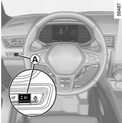
Der Regler **A** wird je nach Fahrzeugbeladung zur Leuchtweitereinstellung der Scheinwerfer verwendet.
