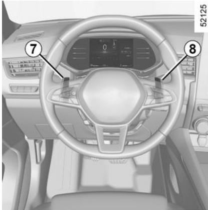
Je nach Fahrzeugmodell können Sie die Schaltwippen **7** und **8** für den Gangwechsel verwenden, wenn sich der Fahrstufenwahlhebel in der Stellung D befindet.
