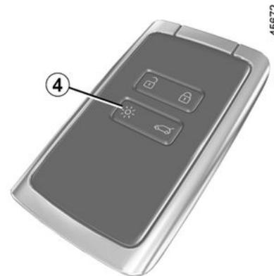
Wenn Sie die Taste 4 drücken, werden das Abblendlicht und die Außenbeleuchtung für ca. 20 Sekunden eingeschaltet. Dies ermöglicht es beispielsweise, das Fahrzeug in einem Parkhaus zu orten.
