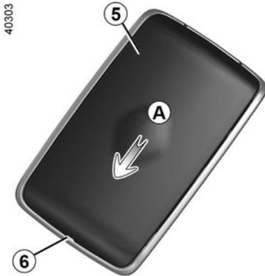
Schieben Sie das hintere Gehäuse **5** nach unten und drücken Sie gleichzeitig auf den Bereich **A**.
