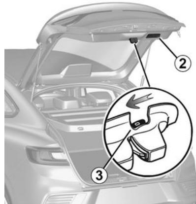
Lässt sich die Heckklappe nicht entriegeln, so kann dies manuell von innen erfolgen:
