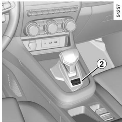
Drücken Sie bei stehendem Fahrzeug, laufendem Motor oder eingeschalteter Zündung die Taste **2** (beim Fahrzeugmodell E-Tech full Hybrid wird auf den Displays und Anzeigen die Meldung READY angezeigt), um in die Stellung P zu schalten. Die Kontrolllampe in der Taste **2** leuchtet orange, sobald die Park-Position P des Automatikgetriebes eingelegt ist.
