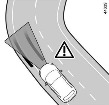
In scharfen Kurven reicht das Lenkvermögen der Funktion abhängig von der Fahrzeuggeschwindigkeit nicht aus, sodass der Fahrer unverzüglich das Steuer übernehmen muss, damit die Funktion das Fahrzeug weiterhin in der Mitte der Fahrspur halten kann.
