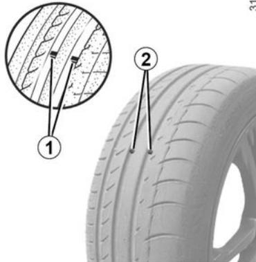
Wenn die Reifenlauffläche bis zum Level der Verschleißwarnstreifen abgefahren ist, **werden sie sichtbar 2: dann müssen die Reifen gewechselt werden, da das Profil jetzt nur max. 1,6 mm tief ist, und der Halt auf nassen Flächen nicht mehr gewährleistet ist.**
