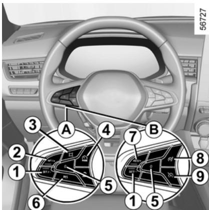
Die Geschwindigkeitsbegrenzerfunktion steuert den Motor, damit Sie die von Ihnen gewählte Fahrgeschwindigkeit, also die **Höchstgeschwindigkeit**, nicht überschreiten.
