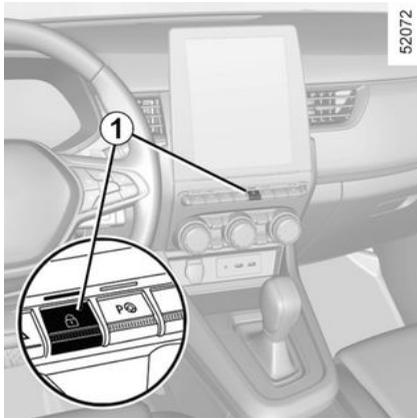
Sobald Sie nach Fahrtbeginn eine Geschwindigkeit von 10 km/h erreichen, löst das System die automatische Verriegelung der Türen/Hauben/Klappen aus.
