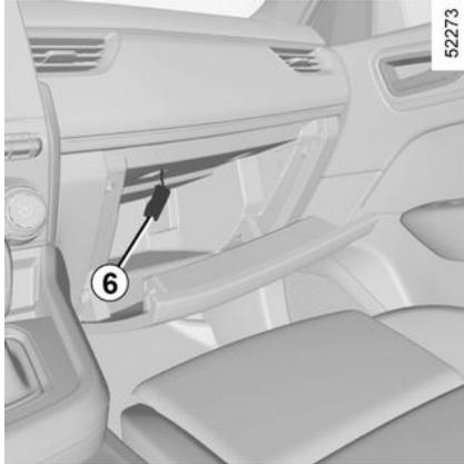
Die Leuchte **6** wird beim Öffnen der Handschuhfachklappe eingeschaltet.
