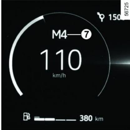
**Hinweis:** Durch Betätigen und Halten der rechten Schaltwippe kehren Sie in den Automatikmodus zurück. Auf den Displays und Anzeigen wird der Automatikmodus D angezeigt.
