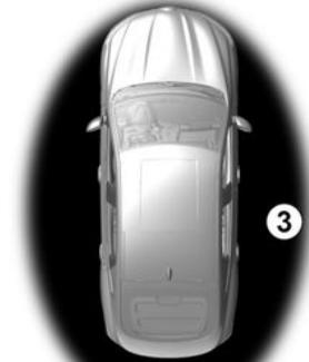
Befindet sich die Keycard in der Zugriffszone **3**, wird das Fahrzeug entriegelt. Die Entriegelung wird durch **einmaliges Aufleuchten** der Warnblinker und der Seitenblinker angezeigt.
