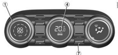
Diese Funktion wird automatisch gesteuert, Sie können sie jedoch auch manuell aktivieren. In diesem Fall wird der Vorgang durch die integrierte Kontrolllampe der Taste **7** bestätigt.
