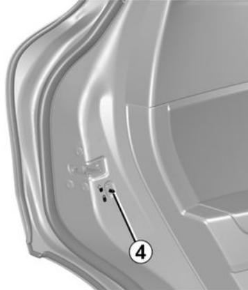
Durch Umlegen des Hebels **4** wird ein Öffnen der Hintertüren vom Fahrgastraum aus verhindert. Vergewissern Sie sich sicherheitshalber, ob die Türen auch wirklich verriegelt sind.
