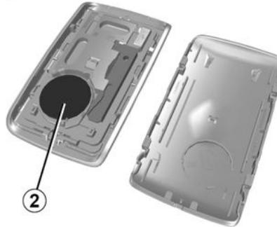
Gehen Sie beim Einsetzen in umgekehrter Reihenfolge vor. Drücken Sie anschließend viermal in Fahrzeugnähe auf eine der Keycard-Tasten: Beim nächsten Startvorgang erscheint die Meldung nicht mehr.
