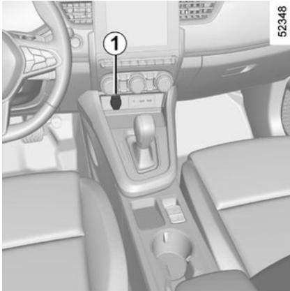
Sie können je nach Fahrzeugmodell den Anschluss **1** oder **2** verwenden. Sie ist für Zubehör vorgesehen, das vom Hersteller geprüft und zugelassen ist.
