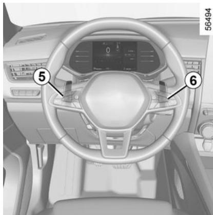
Je nach Fahrzeugmodell können Sie die Schaltwippen **5** und **6** für den Gangwechsel verwenden, wenn der Fahrstufenwahlhebel auf D steht.
