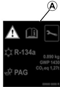
Der Kältemittelkreislauf kann fluorierte Treibhausgase enthalten.
