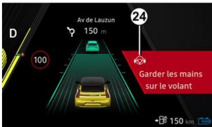
Wenn die „Spurhaltefunktion“ keine Hände am Lenkrad erkennt, wird eine mehrstufige Warnung ausgelöst:
