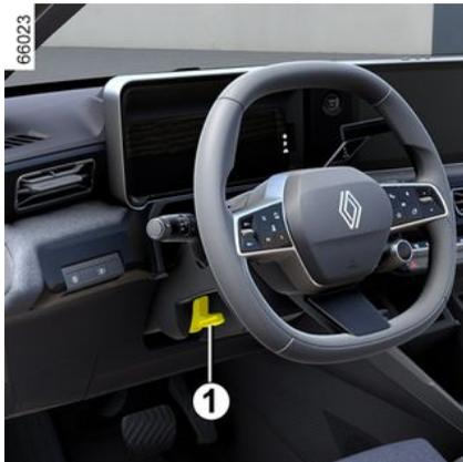
Den Hebel **1** senken und das Lenkrad in die erforderliche Position bringen. Richten Sie dann den Hebel wieder vollständig auf, über den Druckpunkt hinaus, um das Lenkrad zu verriegeln.
