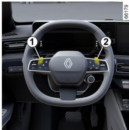
Je nach Fahrzeug können Sie mit den Schaltwippen **1** und **2** die Stufe der Nutzbremmung ändern, wenn sich der Hebel in der Stellung **D** befindet:
