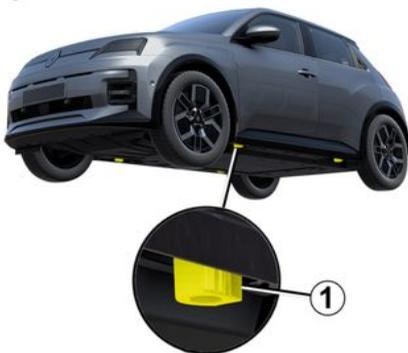
Ihr Fahrzeug ist mit vier dafür vorgesehenen Hebepunkten **1** ausgestattet, die sich unter dem Fahrzeug befinden.
