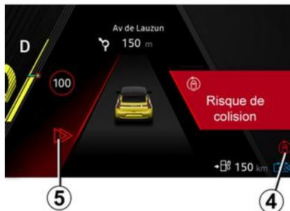
Wenn beim Fahren mit einer Geschwindigkeit zwischen etwa 65 km/h und 110 km/h die Gefahr eines Zusammenstoßes mit einem Fahrzeug besteht, das auf einer benachbarten Fahrspur und innerhalb des Erfassungsbereichs **C** aus der Gegenrichtung kommt, ohne dass der Fahrtrichtungsanzeiger aktiviert wurde, wird das System aktiviert:
