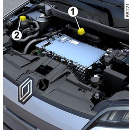
Je nach Fahrzeug kann die Lage der Kühflüssigkeitsbehälter unterschiedlich sein:
