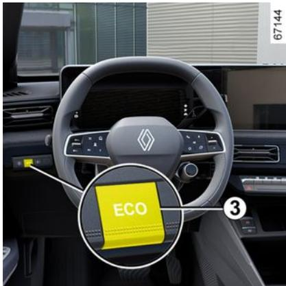
Bei entsprechend ausgestatteten Fahrzeugen drücken Sie den Schalter **3**, um den ECO-Modus zu aktivieren.
