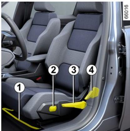
Den Griff **1** zum Entriegeln anheben. Verschieben Sie den Sitz und lassen Sie den Griff in der gewünschten Position los. Vergewissern Sie sich, dass die Verriegelung korrekt einrastet.
