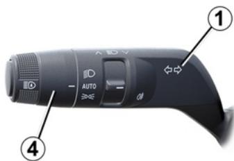
Diese Funktion ermöglicht das kurzzeitige Einschalten von Stand- und Abblendlicht (zum Öffnen eines Tors usw.).
