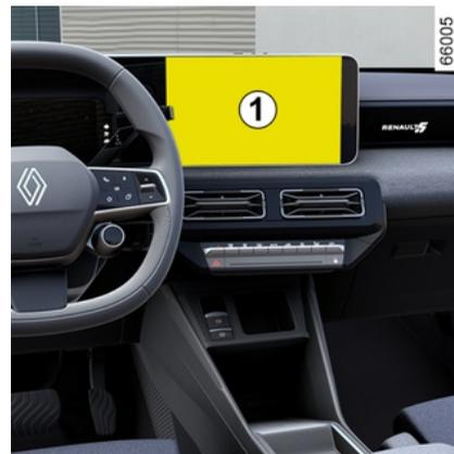
Drücken Sie bei stehendem Fahrzeug und eingeschaltetem Motor in der Welt „Fahrzeug“ **3** auf dem Multimedia-Bildschirm **1** auf das Menü „Elektrisch“ **2** und dann auf die Re-
