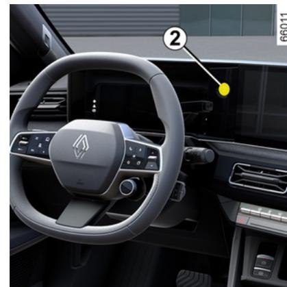
Wenn sich das Smartphone nicht mehr im Fahrgastraum befindet, wenn Sie versuchen, den Motor auszuschalten, wird eine Meldung auf der Instrumententafel angezeigt: Halten Sie die Start/Stopp-Taste des Motors 2 länger als zwei Sekunden gedrückt.
