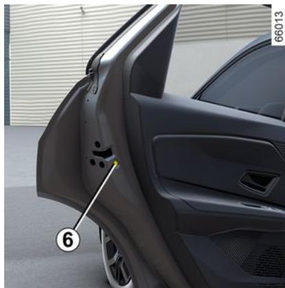
Um zu verhindern, dass die hinteren Türen von innen geöffnet werden können, senken Sie den Hebel 6 und überprüfen Sie von innen, ob die Türen sicher verriegelt sind.
