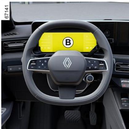
**Instrumententafel A oder B:** Leuchtet auf, wenn die Fahrtür geöffnet wird. Informationen zum Einstellen der Helligkeit des Armaturenbretts finden Sie in den Multimedia-Anweisungen.
