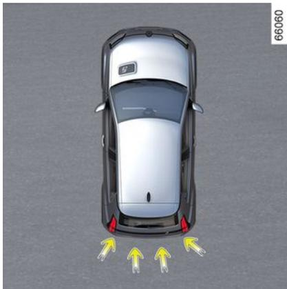
Als Ergänzung zu der Funktion „Parkassistent“ → 286 und anhand der Informationen der vier zentralen Sensoren, die sich am Heck des Fahrzeugs befinden, erkennt das System feste Hindernisse, die sich hinter dem Fahrzeug befinden. Wenn eine erhebliche Kollisionsgefahr besteht, veranlasst das System automatisch eine Bremsung des Fahrzeugs.
