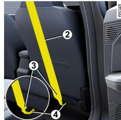
Befestigen Sie den Haken **3** an dem oberen Riemen **2** des Rings **4**, der
