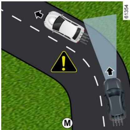
Wenn Sie in eine Kurve einfahren oder an einer Kreuzung abbiegen erkennt das Radar bzw. die Kamera das vorausfahrende Fahrzeug mög-
