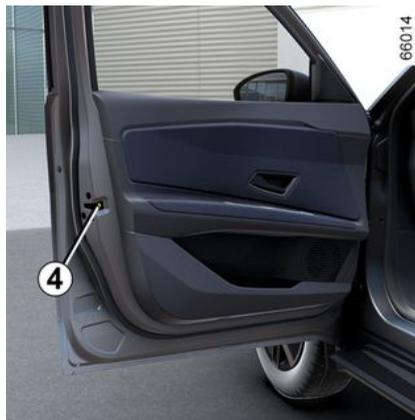
Drehen Sie bei geöffneter Tür die Schraube **4** (mit dem Ende des Schlüssels) und schließen Sie die Tür. Sie ist nun von außen verriegelt.
