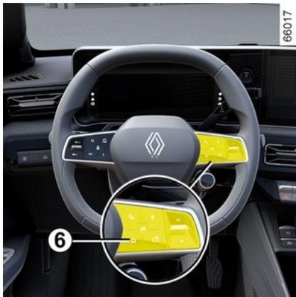
Je nach Fahrzeug können Sie durch Drücken der Lenkradsteuerung **6** das beheizte Lenkrad entsprechend den zuvor gespeicherten Nutzungseinstellungen aktivieren.
