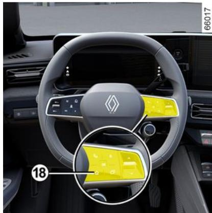
Je nach Fahrzeug können Sie durch Drücken der Lenkradsteuerung **18** folgende Funktionen entsprechend den zuvor gespeicherten Nutzungseinstellungen aktivieren:
