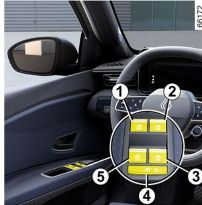
Drücken oder ziehen Sie einen Fensterheberschalter kurz bis an den Anschlag: Das Fenster wird vollständig geöffnet bzw. geschlossen. Durch nochmaliges Betätigen des Schalters können Sie den Vorgang unterbrechen.
