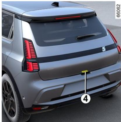
Wenn sich die Karte in der Zone **1** befindet und das Fahrzeug verriegelt ist, drücken Sie einmal auf die Taste **4**, um das gesamte Fahrzeug zu entriegeln.
