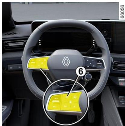
So passen Sie den Sollwert des Geschwindigkeitsbegrenzers, des Tempomaten oder des adaptiven Geschwindigkeitsreglers an die erkannten Geschwindigkeitsbegrenzungen an: Drücken Sie kurz den Schalter 6, um die Geschwindigkeit des Fahrzeugs an die auf dem letzten erkannten Geschwindigkeitsbegrenzungsschild angezeigte Geschwindigkeitsbegrenzung anzupassen.
