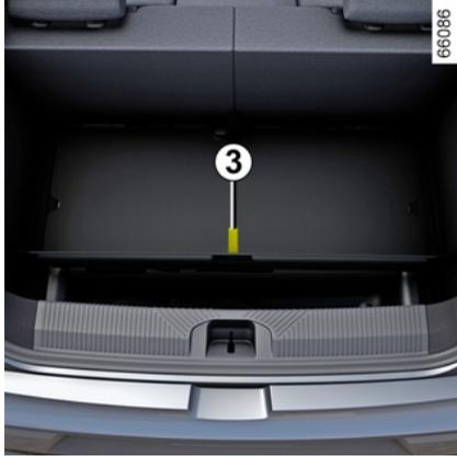
Je nach Fahrzeugausführung ist dieses Ablagefach für die Aufbewahrung von Ladekabeln vorgesehen. Die maximal zulässige Belastung für das Ablagefach beträgt 10 kg.
