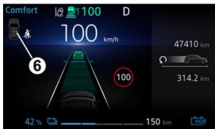
Wenn bei geschlossenen Türen die Zündung eingeschaltet wird, erscheint etwa 60 Sekunden lang die Grafik 6 an der Instrumententafel. Dies informiert den Fahrer jedes Mal über den Anlegestatus der einzelnen vorderen Sicherheitsgurte, wenn:
