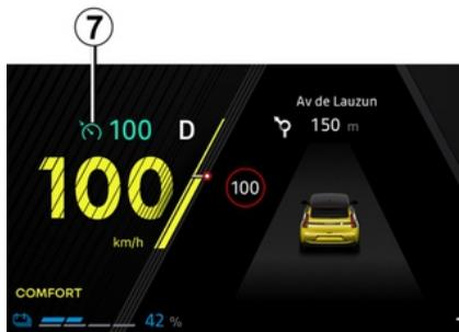
Bei gespeicherter Geschwindigkeit wird die Aktivierung der Geschwindigkeitsregelung durch Anzeige der Regelgeschwindigkeit in grün und, abhängig vom Fahrzeug, die Anzeige der Kontrolllampe **7** bestätigt.
