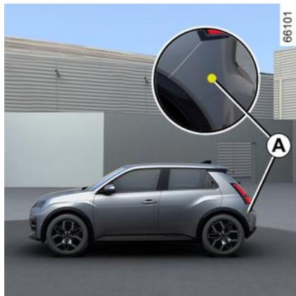
Die Funktion nutzt die Informationen der Radarsensoren auf jeder Seite des hinteren Stoßfängers (Bereich **A**), um den Fahrer zu warnen, wenn sich ein Fahrzeug im Erfassungsbereich **B** nähert.
