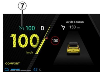
Die Kontrollleuchte **7** erlischt von der Instrumententafel, um zu bestätigen, dass die Funktion deaktiviert ist.
