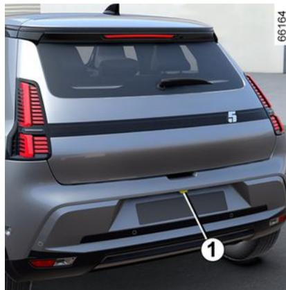
Wenn der Rückwärtsgang eingelegt wird, überträgt die Kamera **1** am Heck des Fahrzeugs auf dem Multi-
