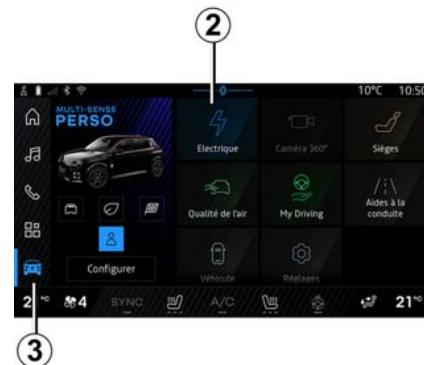
Drücken Sie bei stehendem Fahrzeug und laufendem Motor in der Themenwelt „Fahrzeug“ **3** auf dem Multimedia Bildschirm **1** und dann das Menü „Elektrisch“ **2**, um den Fahrzeugkomfort und/oder Ihr Ladeprogramm zu konfigurieren. Sie können die Registerkarte „Programmierung“ verwenden, um:
