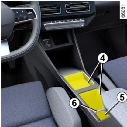
Ein Trenneinsatz **6** ermöglicht es Ihnen, die Ablage in der Mittelkonsole zu organisieren.
