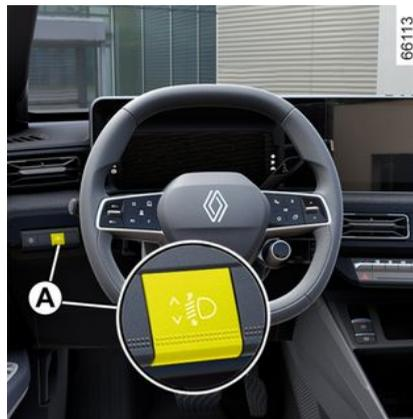
Je nach Fahrzeug kann Leuchtweitereinstellung mit dem Schalter **A** an die Ladung angepasst werden.
