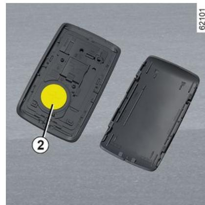
Gehen Sie für den Wiedereinbau in umgekehrter Ausbaureihenfolge vor. Drücken Sie anschließend viermal in Fahrzeughöhe auf eine der Keycard-Tasten: Beim nächsten Startvorgang erscheint die Meldung nicht mehr.
