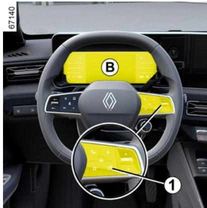
Verwenden Sie, je nach Fahrzeugausführung, das Bedienelement **1**, um die verschiedenen Anzeigen in der Instrumententafel **A** oder **B** durchzublätern und anzusehen.
