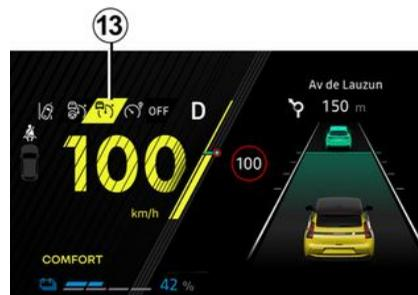
Drücken Sie den Schalter **3**, um den adaptiven Tempomaten an **13** zu aktivieren. Die Warnleuchte **9** leuchtet grau. Die Meldung „Adaptiver Tempomat bereit zum Neustart“ erscheint begleitet von Strichen auf der Instrumententafel um anzuzeigen, dass die Tempomat-Funktion
