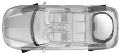
Bei einer Geschwindigkeit über 60 km/h bewegen sich die Hinterräder in die gleiche Richtung wie die Vorderräder (Abbildung **B**), um die Straßenlage des Fahrzeugs zu optimieren. Dies ist nützlich bei Spurwechseln, bei Kurvenfahrten ...
