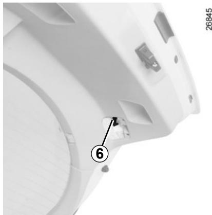
Entfernen Sie die Schraube **6**, um den Schlußleuchtenblock **7** durch Druck nach außen entfernen zu können.
