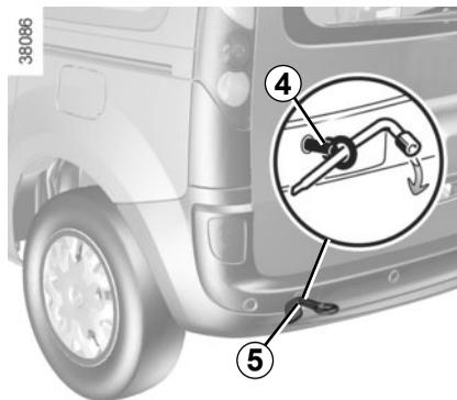
**Utilisez exclusivement les points de remorquage avant et arrière** (jamais les tubes de transmission). Ces points de remorquage ne peuvent être utilisés qu'en traction, en aucun cas ils ne doivent servir pour soulever directement ou indirectement le véhicule.
