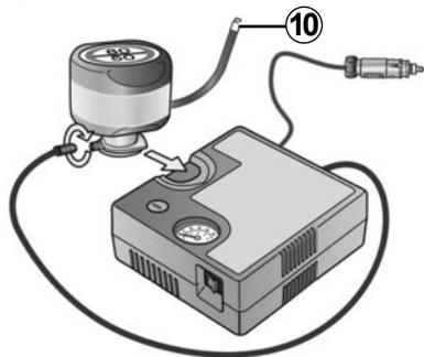
Une fois le pneumatique correctement gonflé, retirez le kit : dévissez lentement l'embout de gonflage **10** de manière à éviter la projection de produit et stockez la bouteille dans un emballage plastique pour éviter l'écoulement du produit.
