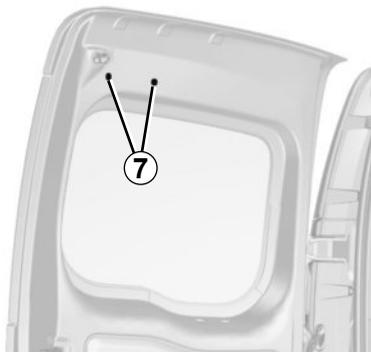
De l'intérieur, retirez les deux obturateurs en plastique **7**. Déclipez le feu à l'aide d'un tournevis en appuyant dans le logement des agrafes métalliques.
