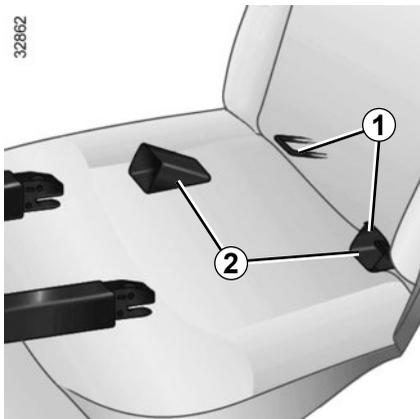
Les deux anneaux **1** sont situés entre le dossier et l'assise du siège, derrière des fermetures à glissière et sont repérés par un marquage.
