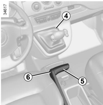
**A la mise en route**, dans le cas où le levier est bloqué sur **P** alors que vous appuyez sur la pédale de frein, il y a possibilité de libérer manuellement le levier. Pour cela, déclippez le cache à l'embase du levier et appuyez simultanément sur le repère **4** et sur le bouton de déverrouillage **6** situé sur le levier.
