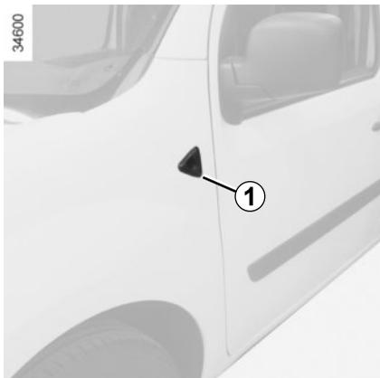
Déclipez le répéteur **1** du côté de la porte, à l'aide d'un outil type tournevis plat.
