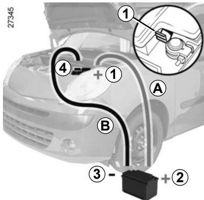
Fixez le câble positif (+) **A** sur la borne (+) **1** de la batterie déchargée, puis sur la borne (+) **2** de la batterie fournissant le courant.
