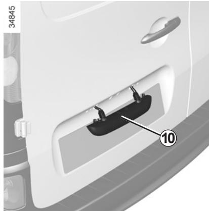
Die Leuchte **10** entfernen, um an die Lampen zu gelangen.
