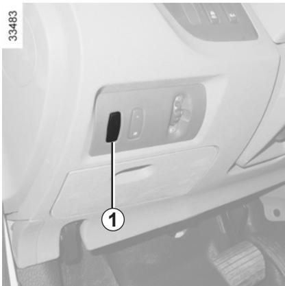
Diese Funktion ermöglicht es, die Fahrzeugautonomie zu optimieren, indem die Motorleistung begrenzt wird.
