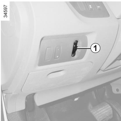
Die Leuchtweite lässt sich mit Hilfe des Rändelrades **1** der Beladung anpassen.
