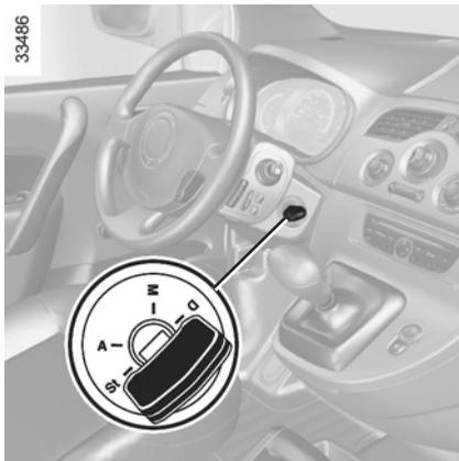
Stecken Sie vor dem Abschleppen den Zündschlüssel in das Zündschloss, um die Lenksäule zu entriegeln. Drehen Sie den Schlüssel auf **M**.
