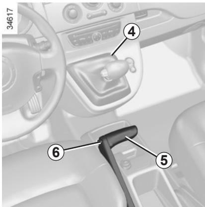
Wenn der Hebel trotz gedrücktem Bremspedal **beim Starten** in Position **P** blockiert ist, kann er von Hand gelöst werden. Hierzu die Hebelabdeckung ausrasten und gleichzeitig auf das Profil **4** und auf den Entriegelungsknopf **6** am Hebel drücken.
