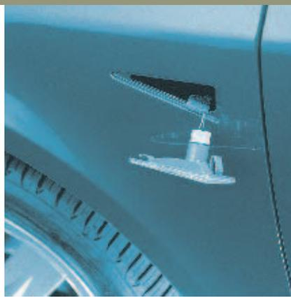
Lampenträger um eine Vierteldrehung lösen und Lampe herausnehmen.
