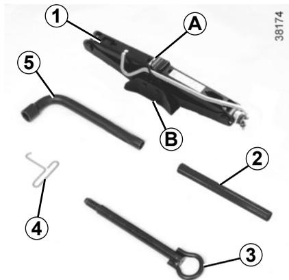
Das Werkzeug für den Radwechsel befindet sich im Gepäckraum unter den Gepäckraummatte. Achten Sie beim Verstauen des Werkzeugs unbedingt darauf, dass der Wagenheber mit der Bodenplatte **B** nach unten zeigt.
