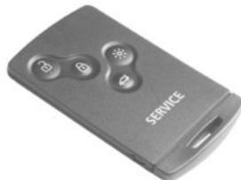
Ist das Fahrzeug mit einer solchen Keycard ausgestattet, ist diese mit der Gravierung SERVICE versehen.
