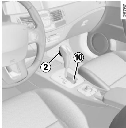
Sollte der Hebel **beim Starten** in Position **P** blockiert sein, auch wenn das Bremspedal betätigt und der Entriegelungsknopf **2** gedrückt wird, kann der Hebel von Hand gelöst werden. Drücken Sie hierzu auf den Knopf, indem Sie einen Gegenstand in die Öffnung **10** einführen, und drücken Sie gleichzeitig auf den Entriegelungsknopf **2** am Hebel.
