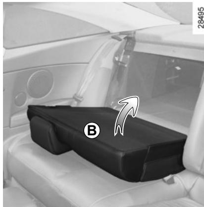
Um die Rückenlehne wieder in Position zu bringen, klappen Sie sie hoch und prüfen Sie die korrekte Verriegelung.
