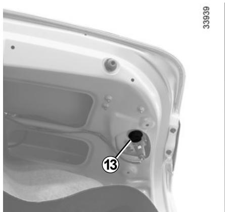
Dévissez le porte-lampe **13** d'un quart de tour dans le sens contraire des aiguilles d'une montre, puis retirez la lampe en tirant dessus.
