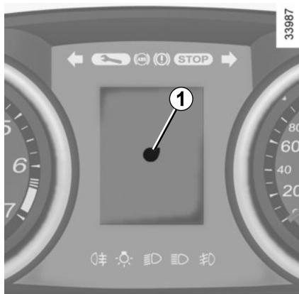
L'indicateur **1** s'allume en fonction du style ou des conditions de conduite et sa couleur passe progressivement de l'orange au jaune ou au vert lorsque la consommation de carburant baisse par rapport à votre style de conduite.
