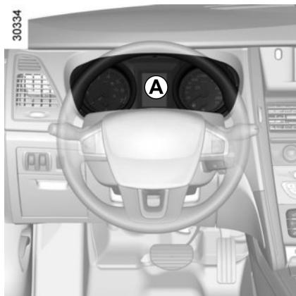
Le **tableau de bord A** s'éclaire à la mise du contact.
