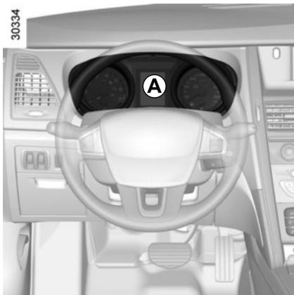
Die **Instrumentenbeleuchtung A** wird bei Einschalten der Zündung aktiviert. Beim Aufleuchten bestimmter Kontrolllampen erscheinen gleichzeitig Meldungen an der Instrumententafel.
